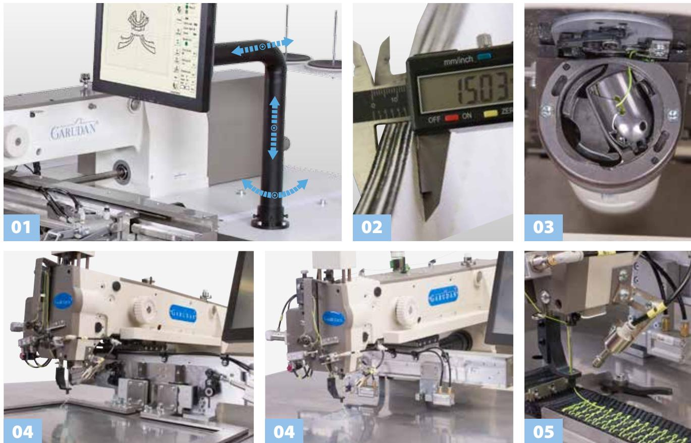
**01** Držák LCD panelu – ergonomický stavitelný držák LCD panelu je standardní součástí dodávky stroje.
